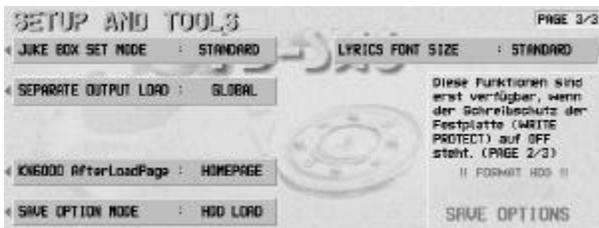
Die Icons der SAVE OPTION und FORMAT HDD werden erst nach dem deaktivieren des Schreibschutzes (WRITE PROTECT = OFF) aktiv.
