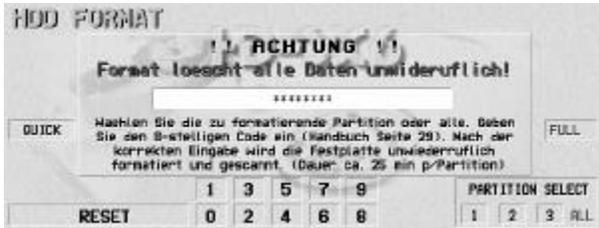
Wählen Sie zwischen einem FULL Format (Dauer: ca. 25 min. p/Partition) mit integriertem Scanning oder dem QUICK Format (Dauer: ca. 3 min. p/Partition) für die nachträgliche Formatierung, z.B. Als einfache, schnelle Löschung alter Daten.
